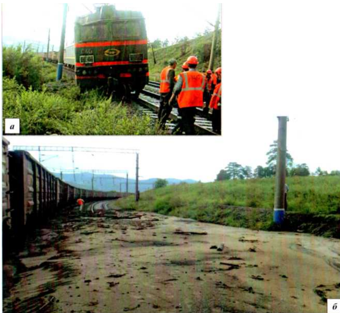
Рис. 5. Сход локомотива с рельсов – результат выпадения ливневых осадков: а – место схода секции локомотива; б – отложения песка и обломков деревьев на железнодорожных путях.
