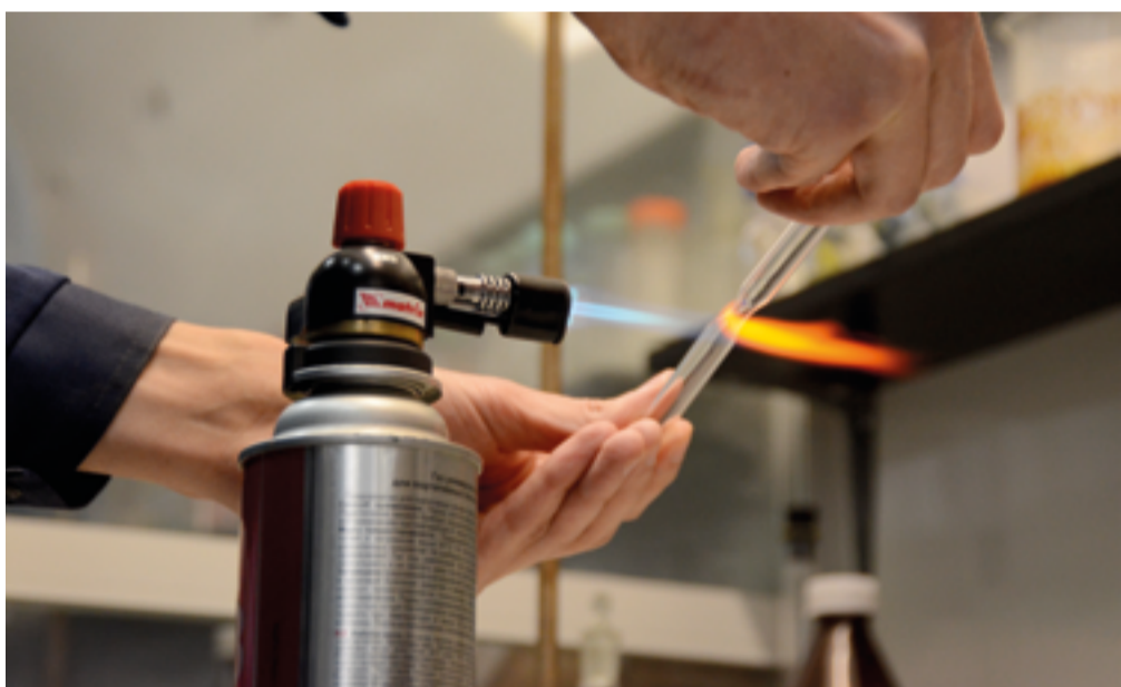
Процесс запаивания ампулы (лаборатория биоактивных неорганических соединений ИНХ СО РАН)
