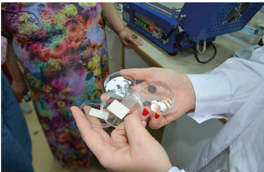
Заготовки с углеродным материалом, нанесенным на медную или алюминиевую подложку, которые потом используются в сборке аккумуляторов
