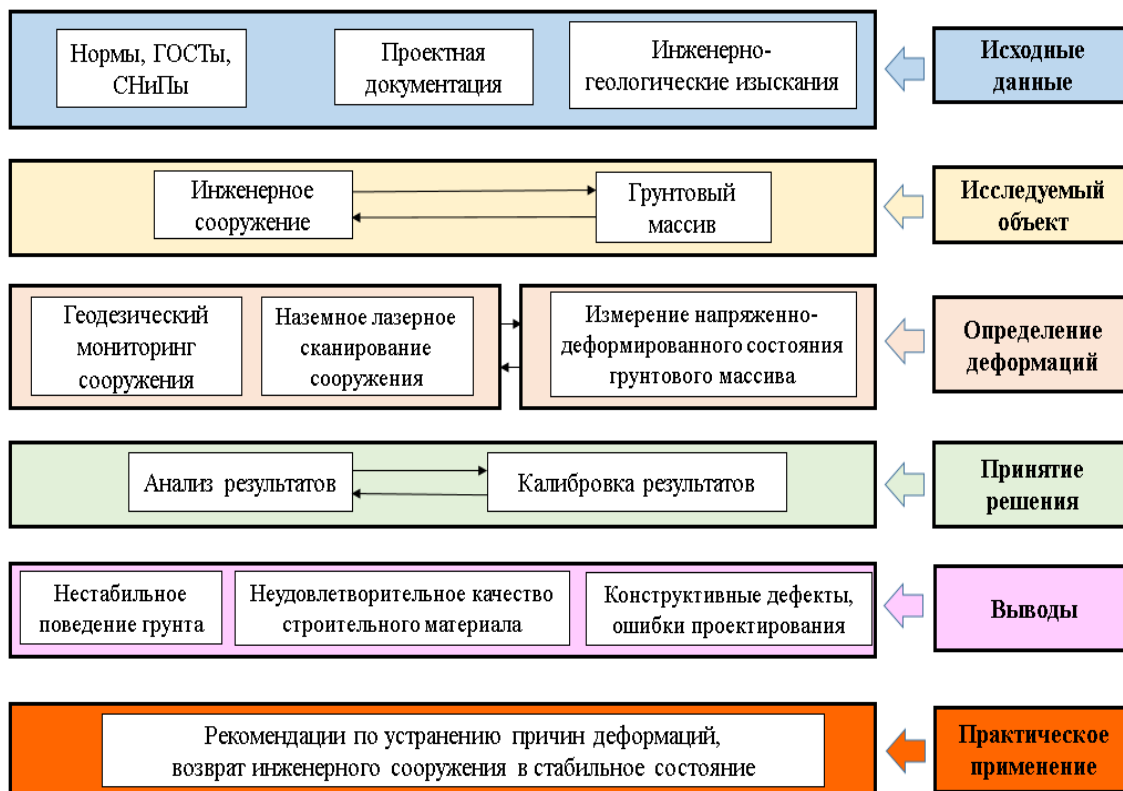
Рис. 10. Общая схема комплексного подхода определения деформаций методом конечных элементов и наземным лазерным сканированием
