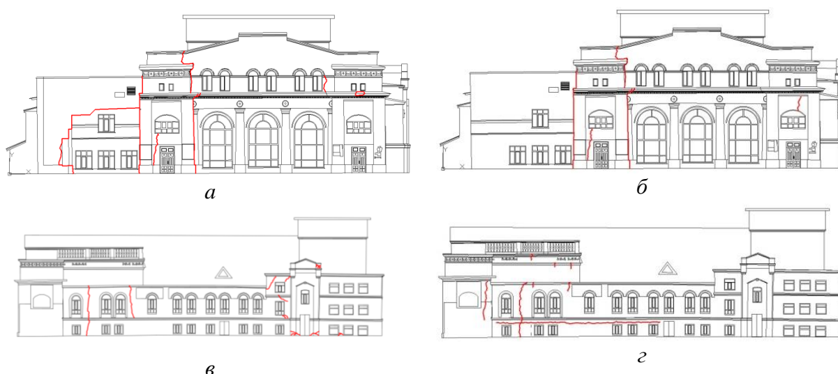
Рис. 4. Трещины фасадов: главного в году: а) 2012, б) 2017 и северного: в) 2012; г) 2017.
